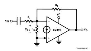
$$\begin{split} A_{V(AC)} &= -\frac{R_f}{R_s} \\ V_{O(DC)} &= V_{BE}(-) \left(1 + \frac{R_f}{R_B}\right) + I_b(-)R_f \end{split}$$
