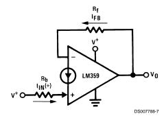
$$\begin{split} &V_{O(DC)} = V_{BE}(-) + I_{FB} \; R_f \\ &I_{FB} = I_{IN}(+) \; A_I + I_b(-) \\ &I_{IN}(+) = \frac{V^+ - V_{BE}(+)}{P} \end{split}$$
