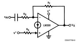
$$\begin{split} A_{V(AC)} &= -\frac{R_f}{R_s} \\ V_{o(DC)} &= V_{BE}(-) + R_f \left[ \frac{V^+ - V_{BE}(+)}{R_b} + I_b(-) \right] \end{split}$$
