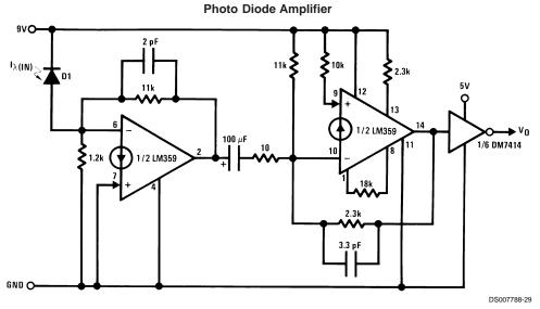
D1 ~ RCA N-Type Silicon P-I-N Photodiode
